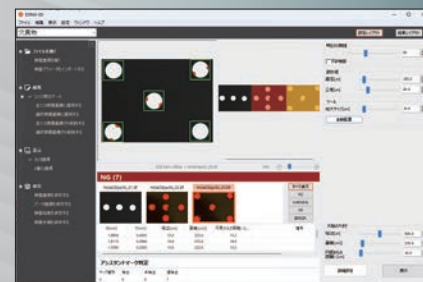
喷淋头孔异物检查
