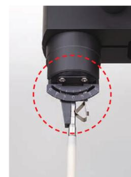
检出器配备安全装置。检出器 (纵向姿势时) 备有可检测 Z 轴方向碰撞的碰撞检测功能。另外，还备有在检出器位移超出范围时停止运行的防意外触碰功能。一旦感应到意外触碰，专用分析软件 (ROUNDPAK) 会提示错误，自动停止设备。
