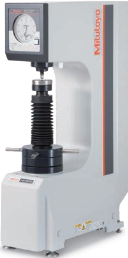
HR-210MR 洛氏硬度计 手动操作更换砝码(总试验力选择)以及加载初试验力。总试验力的加载顺序是马达驱动。
