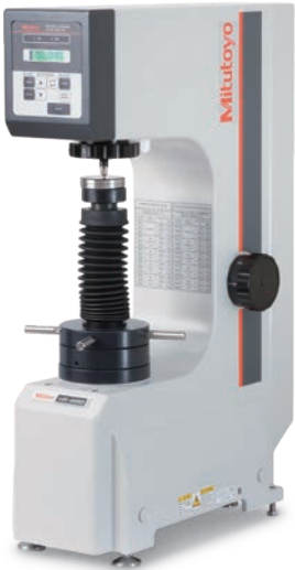
HR-430MS 双洛氏型(洛氏硬度/表面洛氏硬度兼用)硬度计 作为一款灵巧机型，支持手动码盘切换总试验力&具有自动开始功能的自动制动手柄作为标准配备。总试验力的加载顺序是马达驱动。
